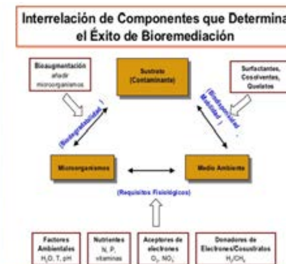
Figura 3. Componentes que interactúan en el proceso de biorremediación. Tomado de es.slideshare.net.
